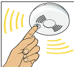
Prova den en gång i månaden. Tryck på testknappen.
