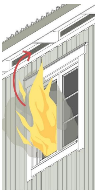
Ventilerad takfot och dess spridningsrisk (Träguiden 2022).
