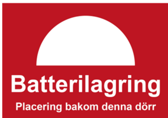
Figur 4: Exempel på skyltning av batterilager (Genberg & Eriksson, 2024)
